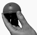
2. Плотно привинтите накладку Night Fishing Cover, таким образом, чтобы отметки уровня воды на локаторе Deeper и полупрозрачной накладке четко совпадали.
